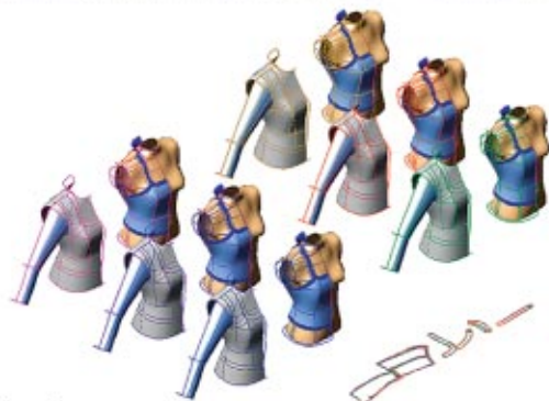
Рис. 1. Автоматическая градация модели методом выполнения всего сценария построения от 3D-модели до готовых лекал
