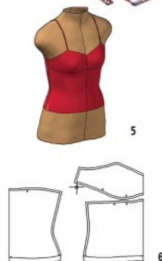
Рис. 12 (5, 6) 5 - Модель топа из эластичного материала 6 - Лекала топа, полученные с учетом эластичности ткани
